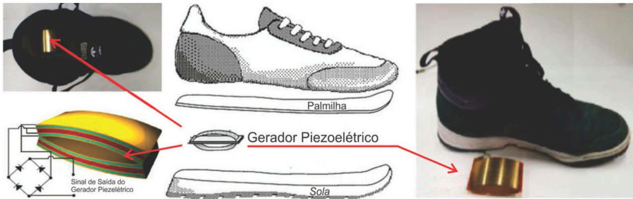
Figura 1: Gerador de energia piezoelétrico instalado entre a palmilha e a sola do calçado. (Imagem adaptada de Shenck, N.S e Jung, W.-S)
