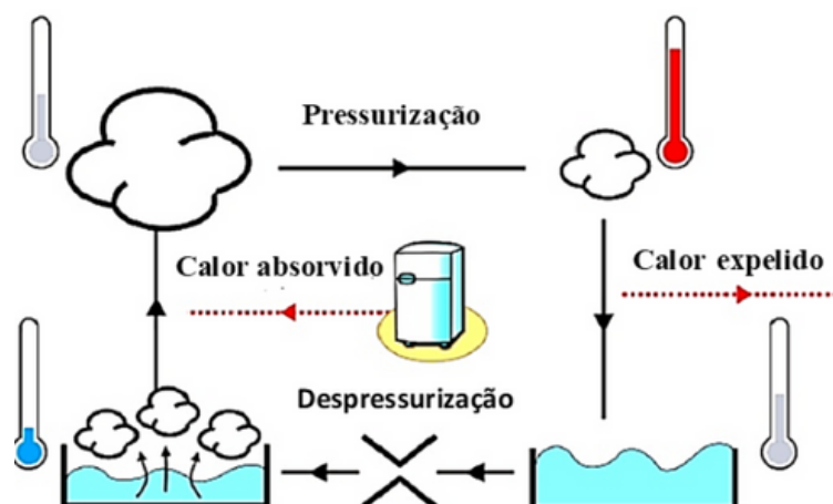
Fig. 3. Esquema do ciclo de compressão de vapor usado em refrigeradores convencionais. Fonte Takeuchi e Sandman [2]
