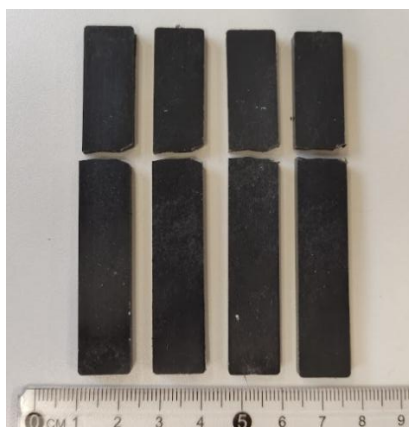
Figura 33: Corpos de prova de Impacto após ensaio.
