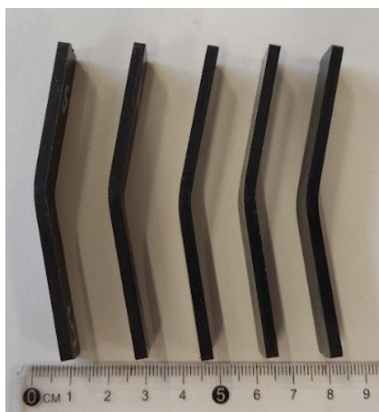
Figura 30: Corpos de prova de Flexão após ensaio.
