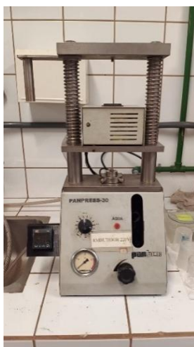
Figura 11: Embutidora metalográfica Manuel Pantec.
