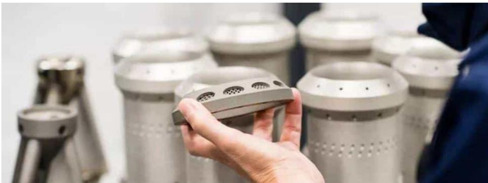
Figura 6: Cabeça de queimador impressa em 3D | Fonte: FacFox[9]
