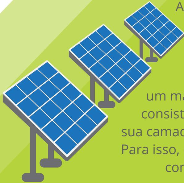
A **construção da placa solar** consiste em duas partes. A primeira é uma **concentração de lacunas na camada de valência**, denominadas tipo P, onde o silício é dopado com um material pentavalente. A segunda parte consiste em um **átomo doador**; ou seja, em sua camada de valência existem mais elétrons. Para isso, o material semicondutor foi alterado com a junção de um material trivalente, também denominado tipo N.
