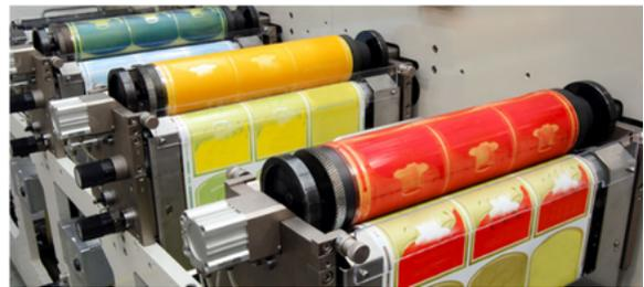
Figura 1: Exemplo de impressão flexográfica. Adaptado de <<https://www.futuraexpress.com.br/blog/flexografia/>>
